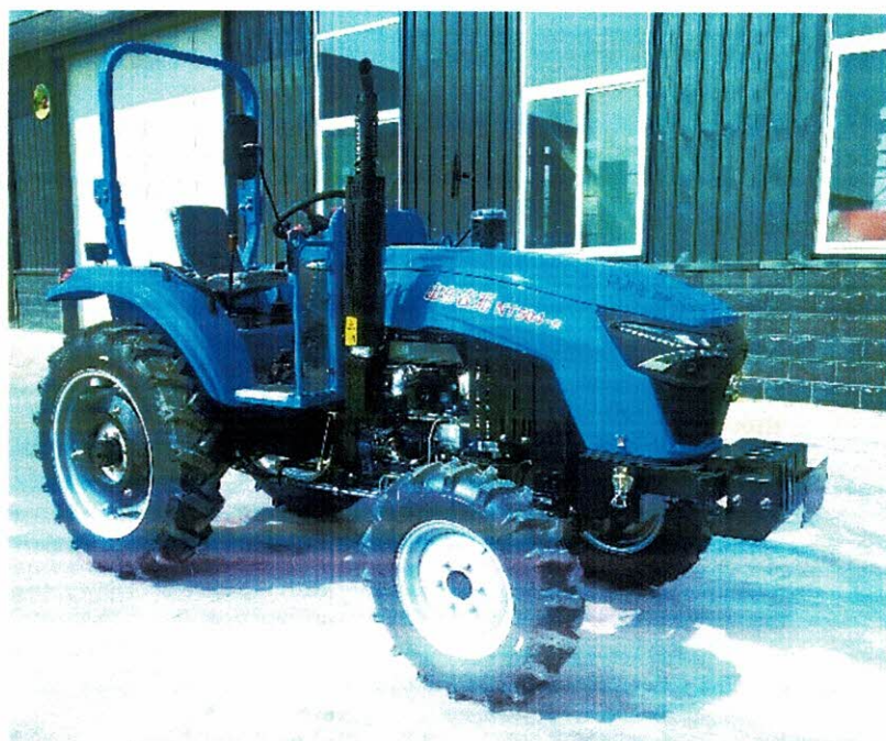
同单元机型 NT504-E 型轮式拖拉机 (选装 YN27HAF4 (国四) 型柴油机)
