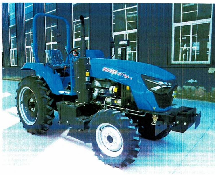
NT704-E 型轮式拖拉机（选装 NT704.2.2 型安全框架）
